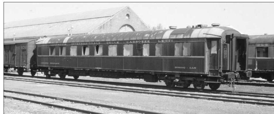
WR 2766 te Oostende. Na zestig werkzame jaren en een modernisering wacht het hier op een volgende bestemming. Goed te zien zijn de dakopbouw, de plaats van de accu's en de plaats waar het monogram zat. Foto K. Wijn Nobel.
